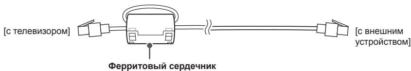
[Вид ферритового сердечника в разрезе]
