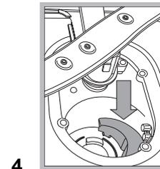
Po wyczyszczeniu filtrów należy ponownie zamontować zespół filtrujący i prawidłowo go umiejscowić; ma to zasadnicze znaczenie dla prawidłowego działania zmywarki.
