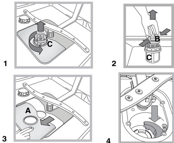
Después de la limpieza de los filtros, vuelva a montar el grupo filtrante y a colocarlo correctamente en su lugar. Esto es fundamental para el buen funcionamiento del lavavajillas.
