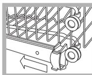
Откройте крепления направляющих корзины справа и слева и выньте корзину. Установите ее сверху или внизу, пропустив ее по направляющим вплоть до входа передних роликов и закройте крепления (см. схему).
