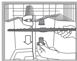
Aby zdemontować górny spryskiwacz, należy odkręcić plastikowy pierścień, obracając go w kierunku przeciwnym do ruchu wskazówek zegara. Górny zraszacz należy zamontować z otworami skierowanymi do góry.
