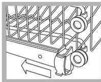
Abra los sujetadores de las guías del cesto, a la izquierda y a la derecha, y extráigalo; colóquelo arriba o abajo, hágalo deslizar a lo largo de las guías hasta hacer entrar también las ruedas delanteras y cierre los sujetadores (ver la figura).
