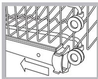
Otvorite kočnice kliznih vodilica police s desne i s lijeve strane i izvucite policu; namjestite je u viši ili u niži položaj, uklizavanjem po vodilicama namjestite i prednje kotačiće te učvrstite kočnice (*vidi sliku*).
