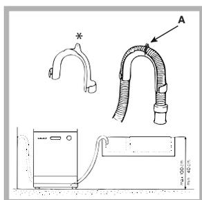
Naročito plastično koljeno\* olakšat će vam uspješno namještanje: dobro učvrstite koljeno na zid da bi spriječili pomicanje cijevi i prolijevanje vode. Dio cijevi označen slovom A mora se nalaziti na visini između 40 i 100 cm od tla (vidi sliku).
