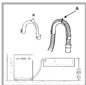
Специальная пластмассовая направляющая\* служит для оптимального размещения сливного шланга: прочно закрепите направляющую на стене во избежание смещения сливного шланга и утечки воды.
