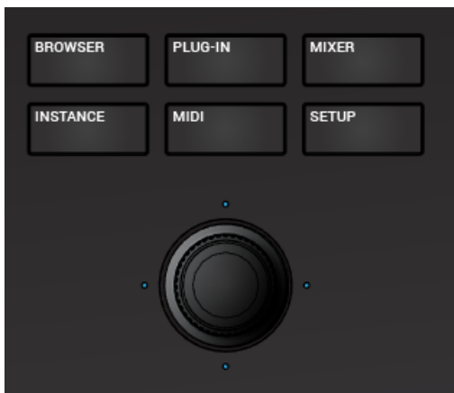
L'encodeur 4D situé en-dessous des boutons Mode.
