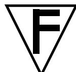
Leuchten, geeignet zur Montage auf normal entflammbaren Befestigungsflächen
