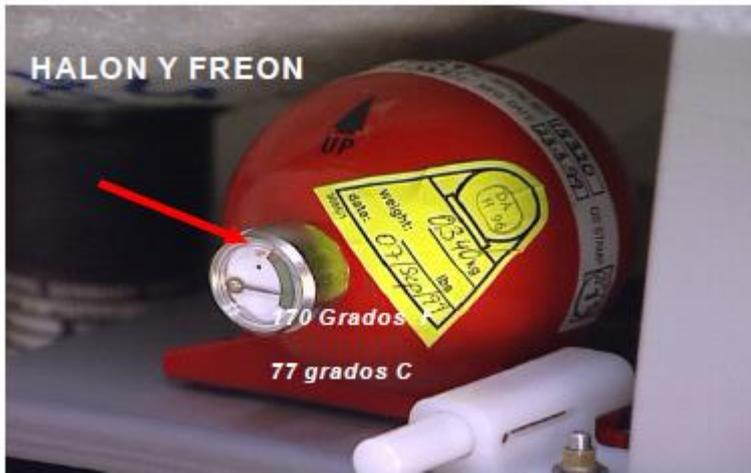
Compuesto de halón.freón, ubicado sobre el compartimento de basura, cuenta con 1 boquilla de descarga dirigida hacia el basurero.
