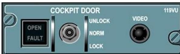
El botón VIDEO instalado en él, permite a la Tripulación de Vuelo seleccionar las imágenes de las diferentes cámaras. El switch COCKPIT DOOR VIDEO, en el panel superior es utilizado para energizar el sistema.
