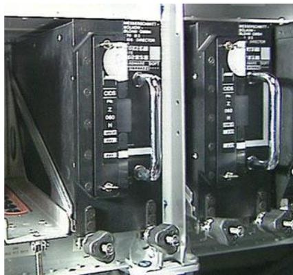
Todos los componentes del CIDS están conectados con dos directores idénticos, uno de ellos en modo activo y el otro en modo espera. Los directores son los componentes centrales del control del CIDS. Supervisan el funcionamiento del sistema continuamente, almacenan fallas detectadas y las envían al sistema de la advertencia del FAP.
