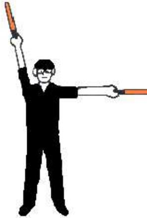
Apunte a la aeronave con el brazo izquierdo y suba el derecho por encima de la cabeza, y en posición vertical.
