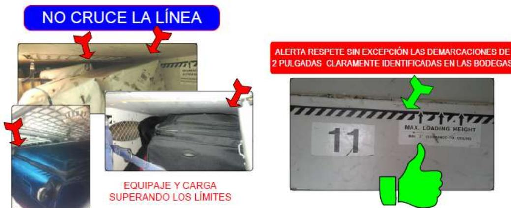
Al momento de cargado de la aeronave, también tomar en cuenta que si el compartimiento de carga está vacío hasta un 25% de su capacidad, las piezas de carga que pesen más de 150 Kg. deben ser aseguradas al piso de la aeronave.
