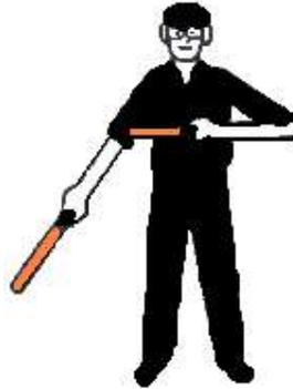
Extienda el brazo derecho hacia abajo y hacia afuera, a la dirección que la cola de la aeronave debe girar. Cruce el brazo izquierdo sobre el pecho. Para aumentar la velocidad del giro, el guía principal moverá la vara que apunta hacia el suelo.
