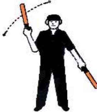
Extienda el brazo izquierdo hacia abajo y sepárelo del cuerpo. Continúe dando la señal de avanzar con el brazo derecho. Cuando la rueda del tren de aterrizaje del tren delantero esté alineada de nuevo, vuelva a hacer la señal de avanzar con las dos varas.
