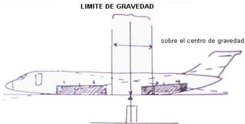
Esta figura muestra como una aeronave posee un espacio de seguridad, sobre el cual el centro de gravedad, puede ser desplazado por fuerzas originadas por pesos tanto delanteros como traseros, dentro del límite de gravedad.
