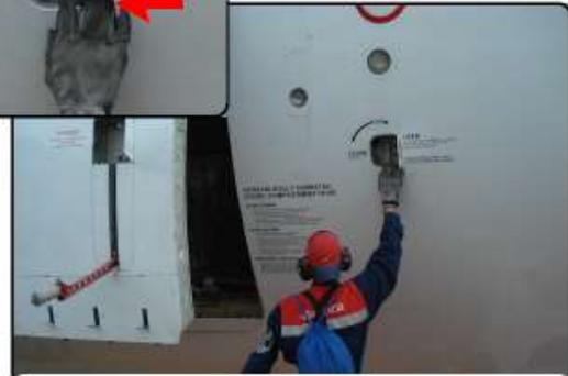
7. Accione la Válvula hacia la señal de open.
