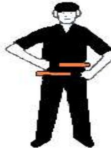
Mantenga las varas paralelas al suelo, una sobre la otra y dejando una separación entre ellas de aproximadamente seis pulgadas. El operador de la aeronave deberá responder moviendo el puño hacia abajo.
