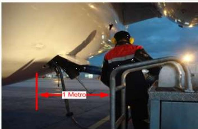
**3. Siempre deténgase como mínimo a 1 metro de distancia entre el carro potable o químico del fuselaje del avión**
