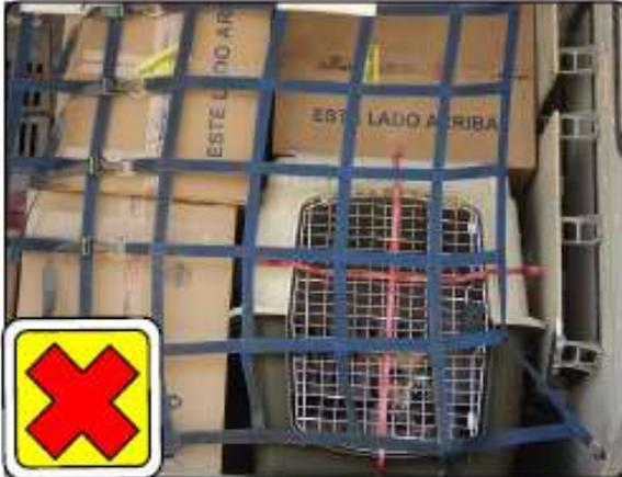
Mascota mal embarcada con cajas encima y sin respetar la indicación de posición.
