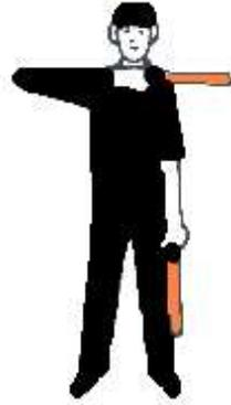
Mantenga la vara derecha sobre el hombro izquierdo, paralela al suelo y pasándola por el cuello. La vara izquierda permanecerá en el lado y extendida hacia abajo. El operador de la aeronave responderá con la misma señal.
