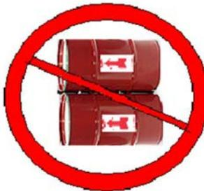
Siempre respetar la etiquetas de manipulación. Al contener líquidos deben siempre ser colocados en posición vertical.
