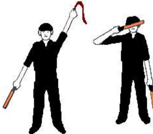
El operador de la aeronave indicará que todo está listo para la salida encendiendo una vez la luz del tren de aterrizaje delantero. El guía principal designado le dará una especie de saludo militar con la mano derecha y mantendrá la izquierda en el lado. Esto le indica a la cabina del piloto que el área está despejada para dirigirse a la pista.
