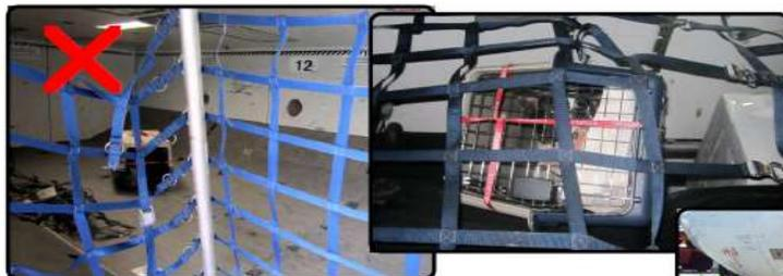
Asegure los guacales con el fin de evitar que se volteen y pueda sufrir daños la mascota o el guacal y termine saliéndose del contenedor
