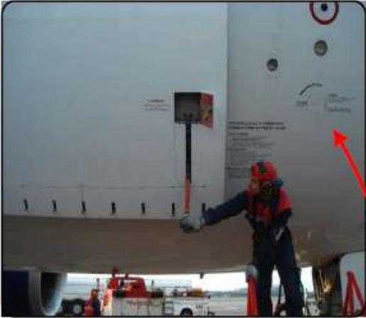
✓ 5. Baje la palanca completamente para poder activar la válvula de apertura hidráulica.
