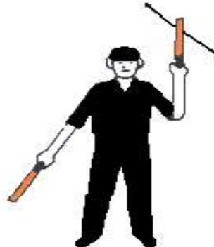
Extienda el brazo derecho hacia abajo y sepárelo del cuerpo. Continúe dando la señal de avanzar con el brazo izquierdo. Cuando la rueda del tren de aterrizaje del tren delantero esté alineada de nuevo, vuelva a hacer la señal de avanzar con las dos varas.
