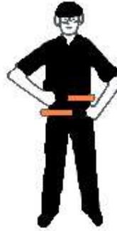
Después de dar la señal de avanzar sujete las varas a la altura del pecho, paralelas al suelo y a una distancia de seis pulgadas entre ellas. Mueva una sobre la otra formando un círculo y alejándolas del cuerpo.
