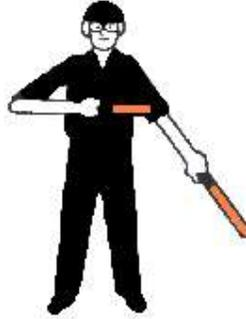
Extienda el brazo izquierdo hacia abajo y hacia afuera a la dirección que la cola de la aeronave debe girar. Cruce el brazo derecho sobre el pecho para aumentar la velocidad del giro, el guía principal moverá la vara que apunta hacia el suelo.
