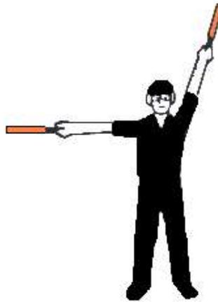
Apunte a la aeronave con el brazo derecho y suba el izquierdo por encima de la cabeza, en posición vertical.
