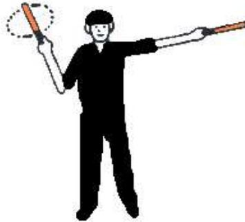
Sujete la vara derecha a la altura de la cabeza y muévala formando un círculo. La vara izquierda deberá apuntar a cada motor, según empiecen a funcionar. Cuando se encienda el motor durante el empuje de salida mantenga el brazo izquierdo en el lado y extendido.
