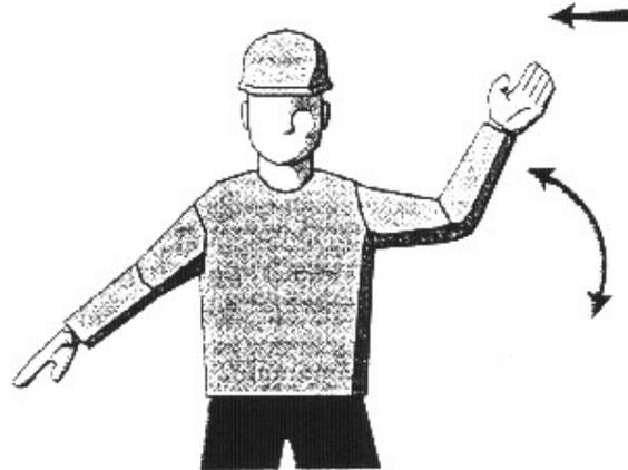
Brazo derecho hacia abajo con la mano extendida, brazo izquierdo en movimiento repetido de abajo hacia arriba en forma lateral. La velocidad de repetición indica la cantidad de giro requerida.
