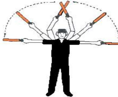
Cuando la aeronave esté de 15 a 20 pies de distancia de las líneas de paradas, extienda ambas varas hacia afuera, a la altura de los hombros y levántelas lentamente hasta el punto en que lleguen a cruzarse por encima de la cabeza. Este movimiento deberá coincidir con el del tren de aterrizaje delantero de la aeronave al llegar a la línea de parada. Las varas se cruzarán en el momento en que la rueda del tren de aterrizaje toque el borde de la línea de parada.
