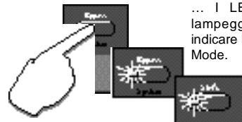
... i LED Bypass e Store lampeggiano lentamente per indicare l'attivazione del System Mode.
