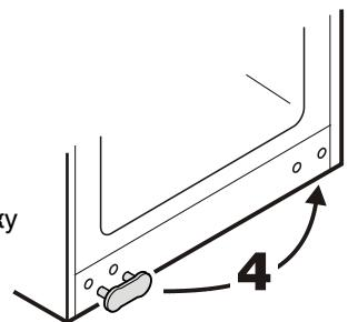
5. Переставить детали шарнира на шарнирном уголке.
