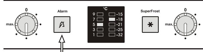
Кнопка выключения звукового предупредительного сигнала
