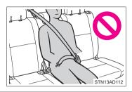
Ne pas utiliser la ceinture de sécurité du siège central de troisième rangée sans deux boucles aue ses ne soient attachées. Fixer une seule boucle pourrait occasionner des blessures graves, voire mortelles, en cas de freinage brusque ou de collision.
