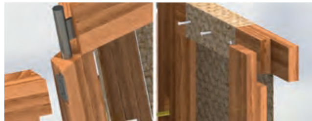
▲ Bisagras para la unión de componentes y ajuste de la tela por medio de tornillos.
