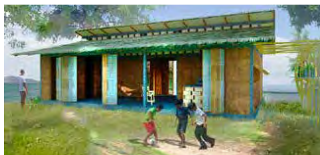
Fachada hacia el patio. Los cerramientos son plegables.
