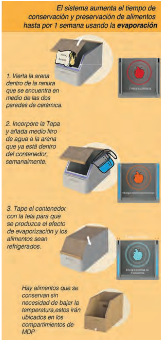
▲ Sistema de enfriamiento por evaporación
