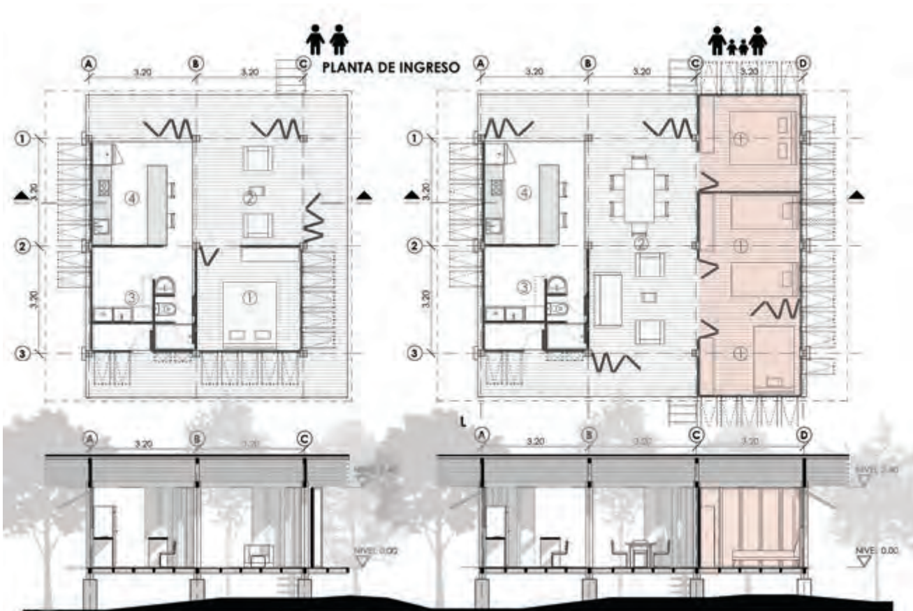
▲ Agrupación compacta concéntrica de módulos. Etapa 1: planta y corte de la unidad básica: 36 m 2 .
