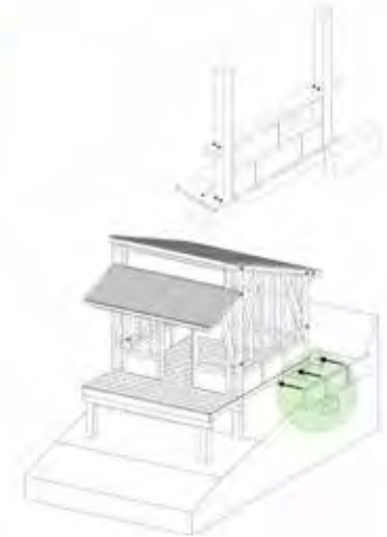
Construcción de los zócalos sobre cuales van los muros tendinosos.
