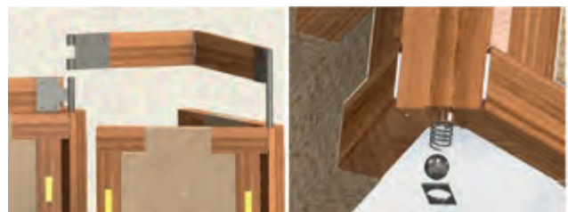
▲ Conexión con posibilidades de rotación de los módulos y sistema de balines para el desplazamiento de las piezas sobre el piso.
