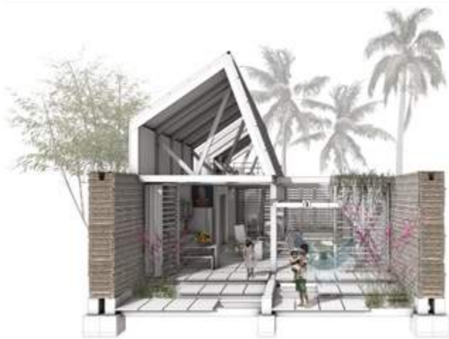
Fachada acceso. El muro en bahareque, además de recoger aguas lluvias, marca un ritmo en fachadas.
