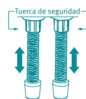
Si los vástagos están cortos o largos, mueva la tuerca de seguridad en los vástagos hacia arriba o hacia abajo hasta encontrar la distancia correcta que garantice el correcto funcionamiento del sistema. Asegure la tuerca central de los vástagos
