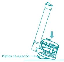
3. Use un destornillador para apretar la platina de sujeción.
