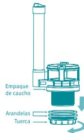
3. Apriete manualmente la tuerca de la válvula lo suficiente para evitar posibles fugas de agua.
