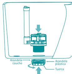
4. Ensamble el cuerpo a la válvula de salida.
