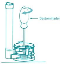
4. Ensamble el cuerpo a la válvula de salida, ubíquelo dentro del tanque y gírelo en sentido a las manecillas del reloj, asegúrelo al resto de la base de la válvula. Revise que quede correctamente instalado.
