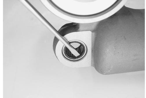
**RODAMIENTO DE AMORTIGUADOR TRASERO**
