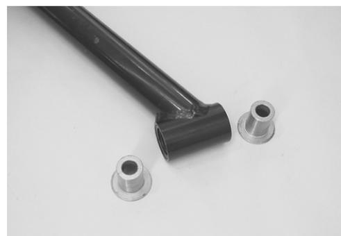
Inspeccione los labios de la junta guardapolvo y los collares por si están desgastados y dañados. Si se encuentra algún defecto cámbielos por otros nuevos.
