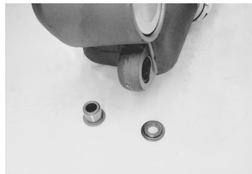
Inspeccione los labios de la junta guardapolvo y los collares por si están desgastados o dañados.
