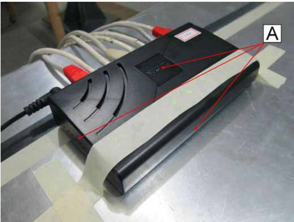
A : Air Discharge, C : Contact Discharge
