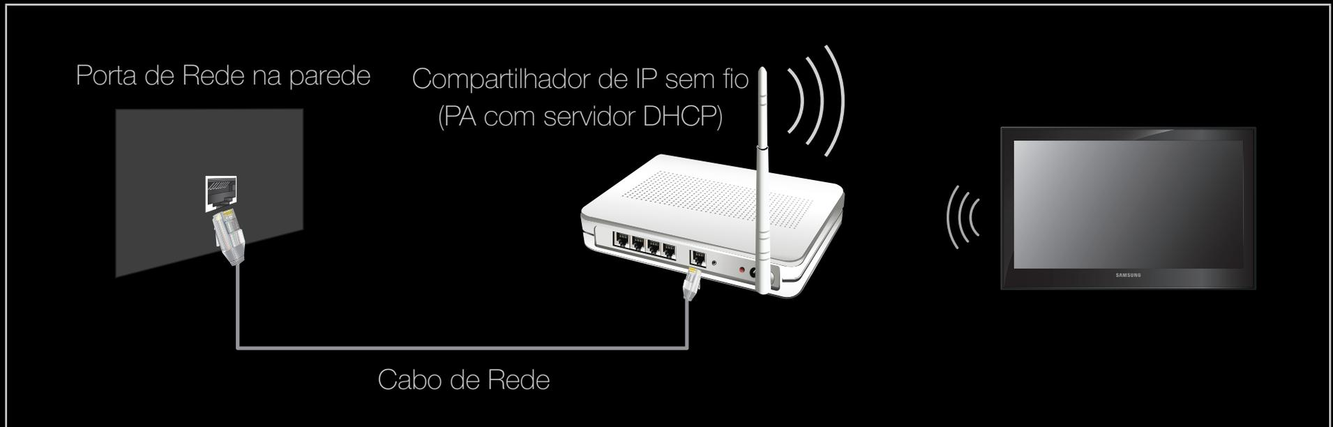
O adaptador de rede sem fio Samsung é compatível com os protocolos de comunicação IEEE 802.11a/b/g e n. A Samsung recomenda a utilização do IEEE 802.11n. Ao reproduzir um vídeo em uma conexão IEEE 802.11b/g, o vídeo pode não ser reproduzido com fluidez.
