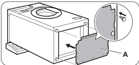
7. Зафиксируйте пластиковую крышку (A), снятую сверху во время распаковки, к дну прибора. Удалите липкую ленту и закройте дно прибора. Приделайте пластиковую крышку к дну прибора, зафиксировав ее маленькими пластиковыми заглушками из пакета с инструкцией по эксплуатации.
