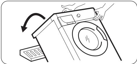
5. Положите элемент упаковки, защищавший прибор спереди, на пол позади прибором. Осторожно положите на него прибор задней стороной. Будьте осторожны, чтобы не повредить шланги.
