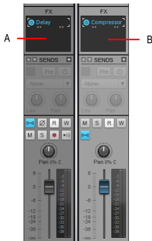
A. Ein Effektcontainer einer Spur in der Mischpultansicht B. Ein Effektcontainer eines Busses in der Mischpultansicht
