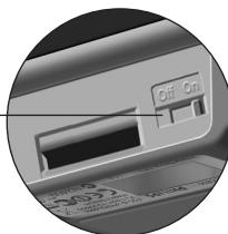
**Consejo** Apague siempre el Control Panel durante el transporte para evitar que se active la pantalla táctil y se descargue la batería.
