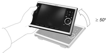
**Remarque** Lorsque le Control Panel est installé sur le secteur et qu'il est relié à un réseau Ethernet, n'inclinez pas le Control Panel pour éviter de débrancher les câbles.
