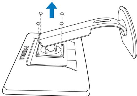
2. Remova os 4 parafusos e depois separe a base do monitor:
