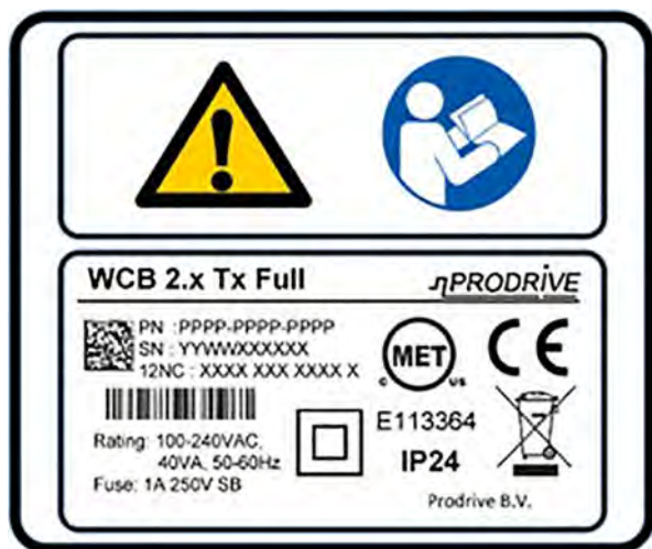
Slika 152 Oznake zidne priključne kutije, 2.x Tx varijanta
