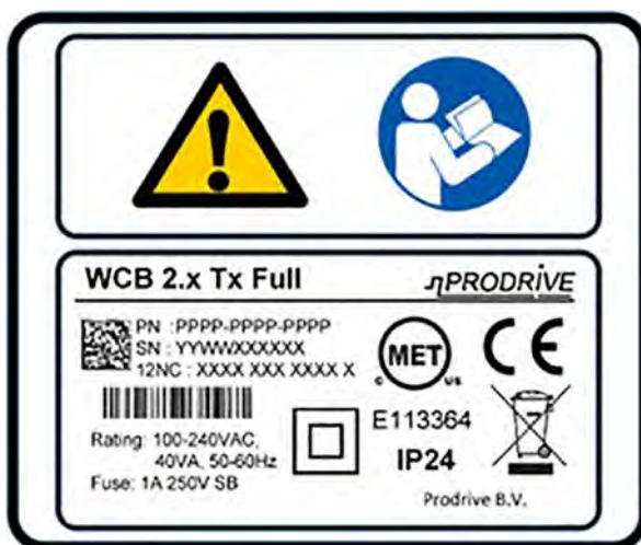
Abbildung 152 Etiketten des Wandanschlusskastens, Variante 2.x Tx
