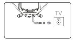
3 Ligue a ficha CC à antena e o transformador a uma tomada CA de 100-240V.
