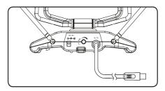
3 Incline ou gire a antena UHF na direcção do transmissor até obter recepção.
