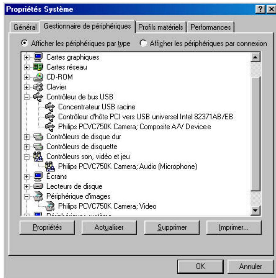
Une section intitulée Contrôleur de bus USB, par exemple, doit s'y trouver. Il convient alors de cliquer sur l'icône en question. Windows indiquera si cet élément du système fonctionne correctement.
