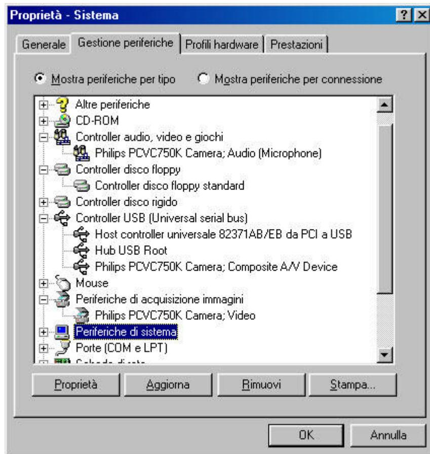
Ad esempio, osservare su USB: dovrebbe essere visibile un'icona con il nome 'Controller USB (Universal serial bus)'. Fare clic su questa icona e Windows segnalerà se questa parte del sistema del computer funziona correttamente. Allo stesso modo, è possibile controllare FireWire e altri controller.
