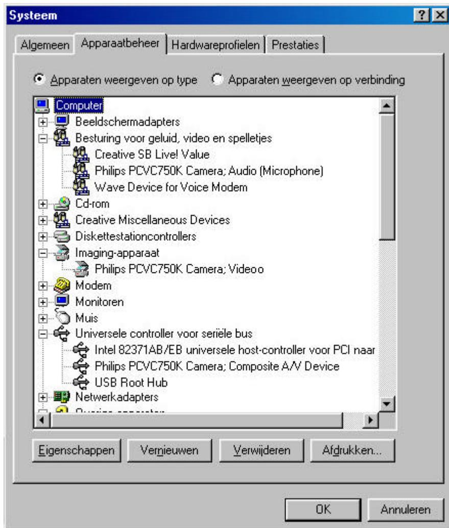
Voor USB geldt bijvoorbeeld het volgende: in de lijst moet een apparaat staan met de naam 'Universele controller voor seriële bus'. Klik op dit apparaat en Windows zal u vertellen of dit deel van uw computer naar behoren werkt. Op dezelfde manier kunt u controleren of bijvoorbeeld uw FireWire-apparatuur werkt.
