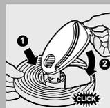
**1** Coloque a lâmina selecionada no disco plástico.
