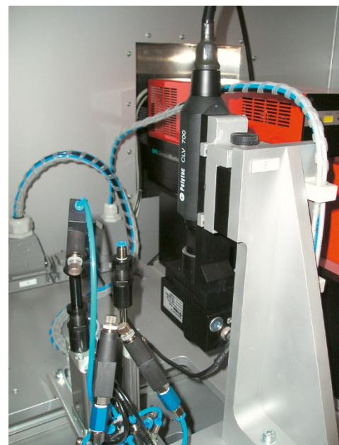
Abb. 8 Integration des Laser-Vibrometers in den Prüfstand (Foto: Pari Pharma/Polytec)
