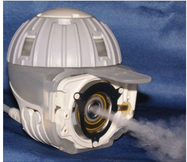
Abb. 2 Ein Piezo-Element regt die Membran des Verneblers zu Ultraschallschwingungen an. Das Fluid wird durch die rund 3000 feinen Löcher der Membran gepresst und so zerstäubt (Pari Pharma)
