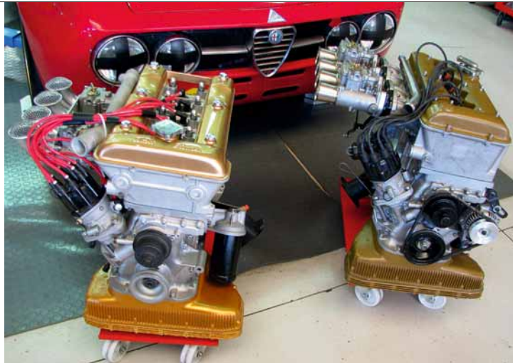
PONTI, MOTORI E CAMBI Sopra, un ponte posteriore in assemblaggio e due motori completi: un GTA 1600 (sinistra) e un GTAm 1750; a fianco, le rispettive auto e sullo sfondo il reparto di assemblaggio motori e cambi. Nell'altra pagina, in verticale una serie di ponti posteriori già assemblati con rapporti dei vari circuiti; poi il vano motore di una GTA Junior pulitissimo e parti di motore e scatole cambi e differenziali sottoposti a trattamento di pulizia e verifica prima dell'assemblaggio.
