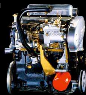
Il Diesel 1301 cc da 45 CV montato anche sulla 127.
