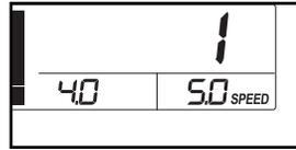
Tras seleccionar un entrenamiento, los ajustes máximos de velocidad e inclinación parpadean en las pantallas durante varios segundos; a continuación, la pantalla mostrará cuánto durará el entrenamiento. En la matriz se muestra un perfil móvil de los ajustes de velocidad del entrenamiento.
