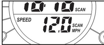
Les lettres *MPH* (miles) ou *KM/H* (kilomètres) apparaîtront dans la partie inférieure du grand affichage pour indiquer l'unité de mesure sélectionnée. Pour changer l'unité de mesure, appuyez sur la touche prendre/remise à zéro pendant à peu près six secondes. Remarque : quand la touche est enfoncée, le ventilateur s'allumera pendant un moment. Quand les piles sont remplacées, il sera peut-être nécessaire de sélectionner à nouveau l'unité de mesure désirée.
