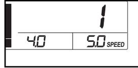
当您选择了某款预置训练程序后，程序的最大速度和坡度设定值将在屏幕上闪烁数秒；然后屏幕将显示程序的持续时间。程序各小节的速度设定曲线图会在屏幕上滚动显示。
