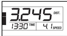
**Priority Display** (优先显示) 按钮直至显示屏上部显示您最想要查看的信息。注意：信息已经在显示屏上部显示时，相同的信息将不会在显示屏左下角或右下角显示。
