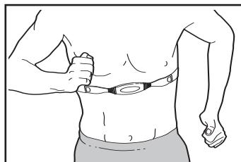
Soulevez le capteur de votre peau de quelques pouces et localisez les deux surfaces des électrodes sur l'intérieur du capteur. Les surfaces des électrodes sont les deux rectangles creux. A l'aide de solution saline tel que de la salive ou de la solution pour lentilles de contact, mouillez les deux surfaces des électrodes. Replacez le capteur sur votre peau.
