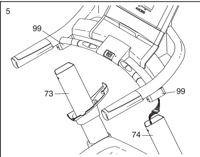
6. Serrez à l'aide des doigts trois Boulons de la Rampe (64) accompagnés de trois Rondelles Étoilées (90) à l'intérieur du Montant Droit (74). Ensuite, serrez à l'aide des doigts trois Boulons de la Rampe accompagnés de trois Rondelles Étoilées (non montré) à l'intérieur du Montant Gauche (73). Serrez enfin les six Boulons de la Rampe fermement.
