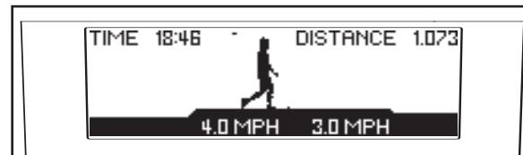
A la fin du premier segment d'une minute du programme, une série de tonalités se font entendre. Si un réglage différent est programmé pour le deuxième segment, le réglage de la vitesse se déplace le long du bas de l'écran pour vous alerter. Si un réglage différent de l'inclinaison est programmé, le réglage de l'inclinaison apparaît pendant quelques secondes en haut de l'écran. Le tapis de course ajuste alors automatiquement les réglages de la vitesse et de l'inclinaison pour le deuxième segment.
