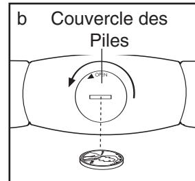
Retirez la vieille pile de l'unité du moniteur. Insérez une nouvelle pile CR2032, en vous assurant que les lettres sont au-dessus. De plus, **assurez-vous que la rondelle en caoutchouc est placée correctement dans l'unité du moniteur.** Refermez le couvercle de la pile et tournez-le dans la position fermée.
