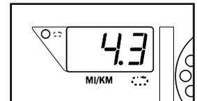
**Pantalla de inclinación/tiempo**—Esta pantalla muestra el tiempo transcurrido y el nivel de inclinación de la caminadora. La pantalla se alternará entre un número y el otro cada siete segundos; el indicador se prenderá cuando la inclinación se muestre. Nota: Cuando un programa de entrenamiento se seleccione, la pantalla mostrará el tiempo que queda en el programa.
