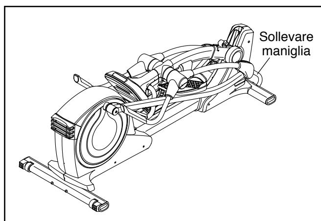
Una volta terminato lo spostamento dell'ellittico, sollevare il montante in posizione verticale e serrare la manopola montante.
