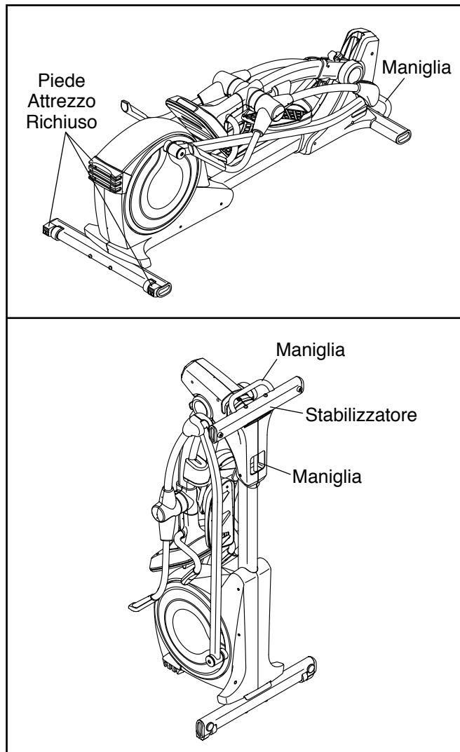
Per aprire l'ellittico e utilizzarlo, afferrare la maniglia sul telaio con una mano e reggere lo stabilizzatore anteriore con l'altra mano. Quindi, tirare il telaio verso di sé e aprirlo fino a quando è possibile afferrare la maniglia sullo stabilizzatore anteriore. Infine reggere la maniglia sullo stabilizzatore anteriore con entrambe le mani e terminare l'apertura dell'ellittico.
