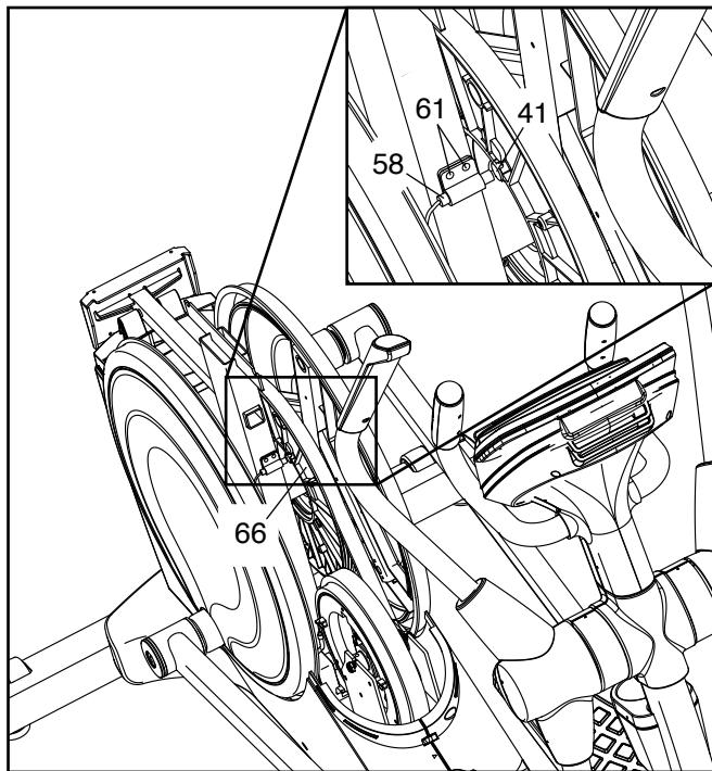
Quindi allentare, ma non rimuovere, le due Viti M4 x 16mm (61) indicate. Inserire il Commutatore (58) leggermente più vicino o lontano dal Magnete (41). Riserrare infine le Viti M4 x 16mm.
