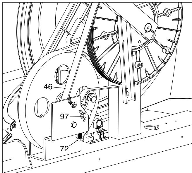
Una volta terminato, rimontare il pannello sinistro, il disco pedale sinistro, il pannello superiore, il piede grande attrezzo richiuso e il braccio pedale sinistro. Inserire poi l'alimentatore.
