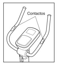
Para medir su ritmo cardiaco, sostenga el sensor de pulso del mango, con las palmas de las manos descansando en los contactos metálicos. Evite mover las manos u oprimir los contactos en forma demasiado fuerte.
