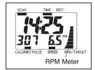
revoluciones por minuto (rpm). Mientras aumente o disminuya su paso de pedaleo, indicadores aparecerán o desaparecerán en el medidor de RPM. **Tiempo [TIME]**—Esta función muestra el tiempo que ha pasado. Nota: Cuando un entrenamiento de paso es seleccionado, la pantalla muestra el tiempo que falta en el entrenamiento en vez del tiempo que ha pasado.
