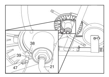
Luego, gire la perilla de resistencia al punto más bajo. Con el protector izquierdo retirado, localice el Interruptor de Lengüeta (39). Gire la Manivela (21) hasta que un Imán (38) esté alineado con el Interruptor de Lengüeta. Afloje, pero no quite, el Tornillo de M5 x 15mm (47) indicado. Deslice el Interruptor de Lengüeta un poco cerca o alejado del Imán, y entonces vuelva a apretar el Tornillo. Dé vuelta a la Manivela por un momento. Repita hasta que la consola muestre información correcta.
