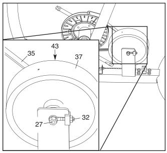
Luego, afloje la Tuerca de 3/8" (27) y la Tuerca del Volante (43), que están localizados a cada lado del Volante (37). Luego, ajuste las Contratuercas de M6 (32), una en cada lado del Volante, hasta que la Correa (35) esté ajustada apropiadamente.
