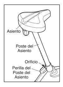
poste del asiento hacia arriba o hacia abajo y alinee uno de los orificios de ajuste en el poste del asiento con el orificio indicado de la armadura. Inserte la perilla del poste del asiento dentro de la armadura y el poste del asiento, y luego ajuste la perilla del poste del asiento. Asegúrese que la perilla esté insertada por uno de los orificios de ajuste en el poste del asiento.
