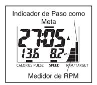
Mientras que el indicador del paso como meta cambie en altura durante el entrenamiento, ajuste su paso de pedaleo para que ambos indicadores estén a la misma altura. Si su paso de pedaleo es más lento que el paso como meta fijado actual, una flecha hacia arriba aparecerá al lado del medidor de RPM para avisarle que aumente su paso, si su paso está más rápido que el paso como meta, una flecha hacia abajo le avisará que disminuya su paso.
