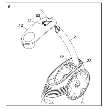
Richten Sie die Computer-Platte (11) so aus, wie abgebildet. Schieben Sie dann das Hauptkabel (53) und das Rahmenpulskabel (42) nach oben durch die Computer-Platte.
