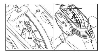
Drehen Sie als nächstes die Rolle (43) bis ein Magnet (44) mit dem Membranenschalter (46) abgestimmt ist. Schieben Sie den Membranschalter zum Magnet hin oder davon weg. Ziehen Sie dann die M4 x 16mm Schraube (61) wieder fest.
