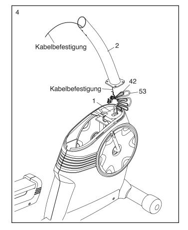
Tipp: Vermeiden Sie ein Abklemmen der Kabel. Setzen Sie den Pfosten (2) auf den Rahmen (1) auf.
