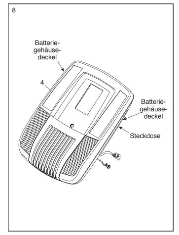
Verbinden Sie die Kabel am Computer mit dem Hauptkabel (53) und dem Rahmenpulskabel (42), während eine zweite Person den Computer (4) an die Computer-Platte (11) hält.
