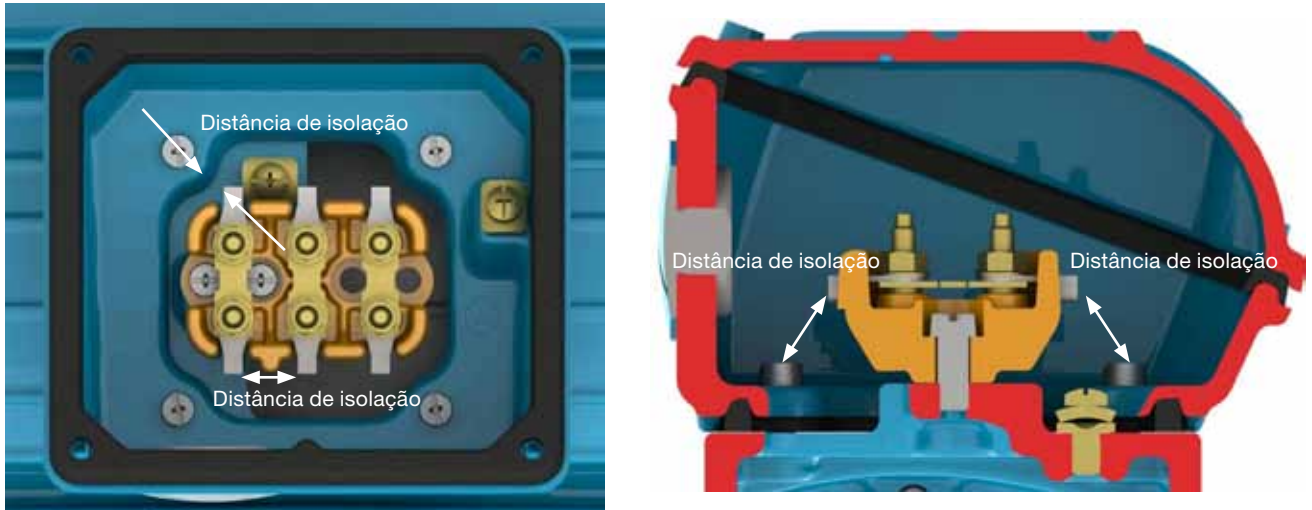
Figura 6.13 - Representação da distância de isolamento.
