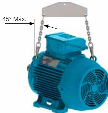
Figura 4.4 - Ângulo máximo resultante para motores com dois ou mais olhais de içamento
