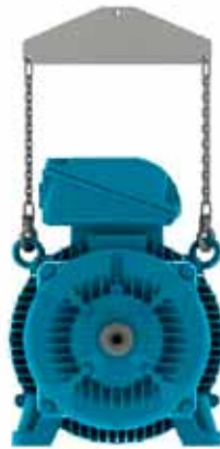
Figura 4.6 - Uso de barra separadora en el izamiento
