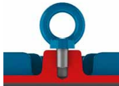
Figura 4.2 - Manera incorrecta de fijación del ojal de izamiento
