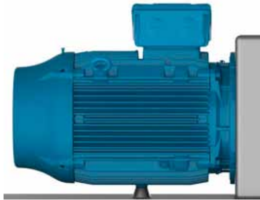
Figura 6.7 - Representação da fixação do motor com flange e apoio na base da carcaça
