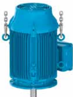
Figura 4.16 - Instalación del primer par de ojales
