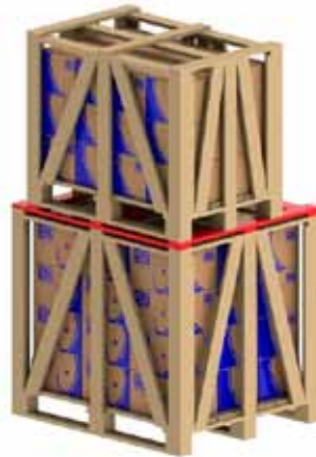
Figura 5.5 - Utilización de varas adicionales para apilamiento
