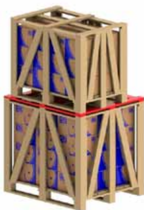
Figura 5.5 - Utilização de sarrafos adicionais para empilhamento
