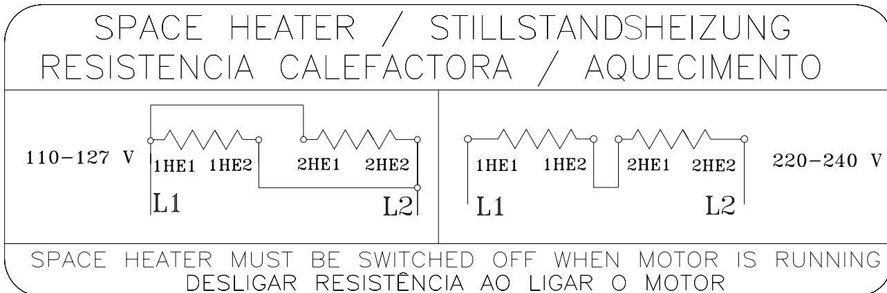
Bild 6.17 - Schaltbild der Stillstandsheizung für 110-127/220-240 V
