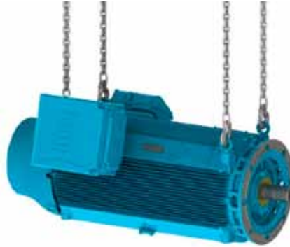
Figura 4.12 - Izamiento del motor HGF utilizando dos grúas
