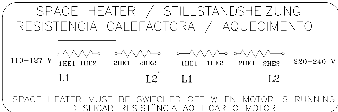
Figura 6.17 - Esquema de ligação da resistência de aquecimento para tensão 110-127/220-240 V.
