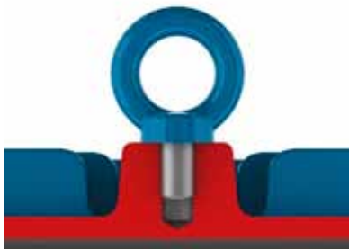
Bild 4.1 - Richtige Befestigung der Transportösen
