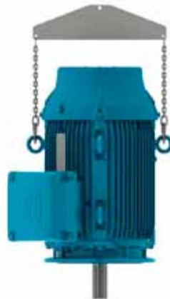
Figura 4.7 - Izamiento de motores verticales
