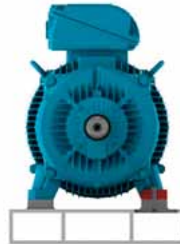
Figura 6.3 - Motor instalado sobre base metálica
