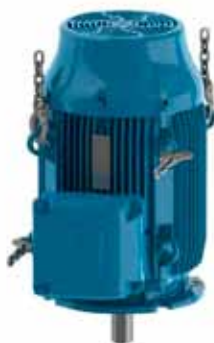
Figura 4.17 - Instalación del segundo par de ojales
