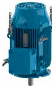
Figura 4.17 - Instalação do segundo par de olhais
