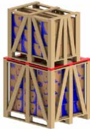
Figura 5.5 - Utilización de varas adicionales para apilamiento
