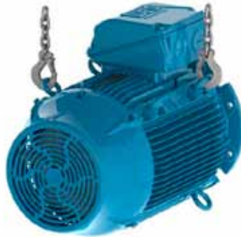
Figura 4.9 - Remoção do motor da embalagem
