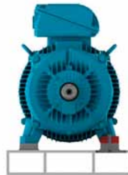
Figura 6.3 - Motor instalado sobre base metálica
