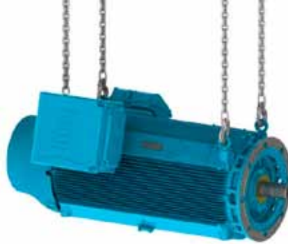
Bild 4.12 - Den Motor der Baureihe HGF an den vier seitlich angebrachten Transportösen mit zwei Hebevorrichtungen heben
