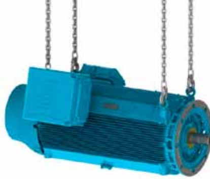
Figura 4.12 - Izamiento del motor HGF utilizando dos grúas
