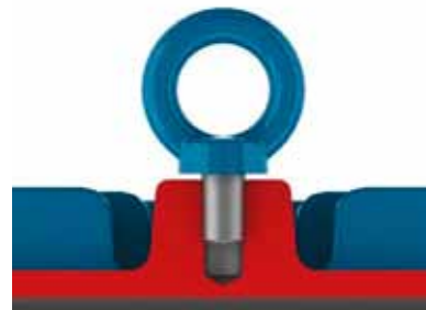
Bild 4.2 - Falsche Befestigung der Transportösen
