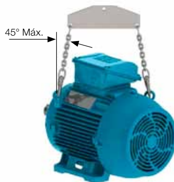
Bild 4.4 - Max. zugelassener Hebewinkel für Motoren mit zwei oder mehreren Transportösen
