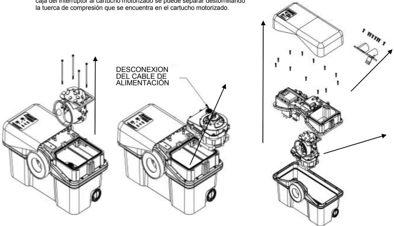
**4-3-6 Extracción de bloqueos del rotor / reemplazo del rotor:**
