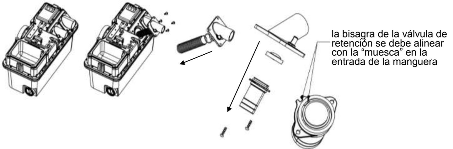
**4-3-4 Tapa de acceso:** la tapa de acceso está fijada a la tapa principal con cinco sujetadores. Si fuera necesario, use una llave Allen de 0.5 cm (3/16 de pulgada) para aflojar los sujetadores. Cuando se retiren los tornillos, se podrá levantar la tapa de acceso. Es posible que necesite manipularla un poco si el macerador se encuentra directamente debajo del tanque de depósito del inodoro.
