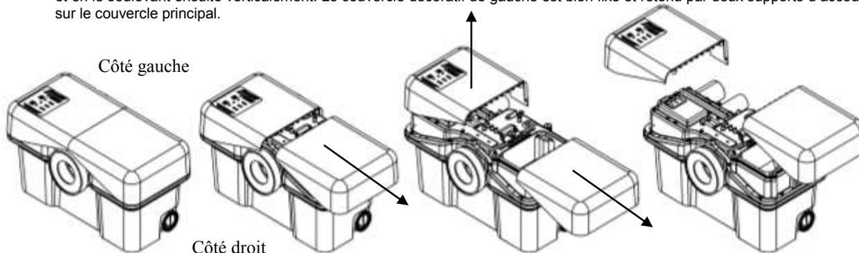
**4-3-2 Brides d'évacuation et de ventilation :** Les brides d'évacuation et de ventilation sont fixées toutes les deux au couvercle principal et peuvent être enlevées en dévissant les quatre fixations et en retirant la bride du couvercle principal.
