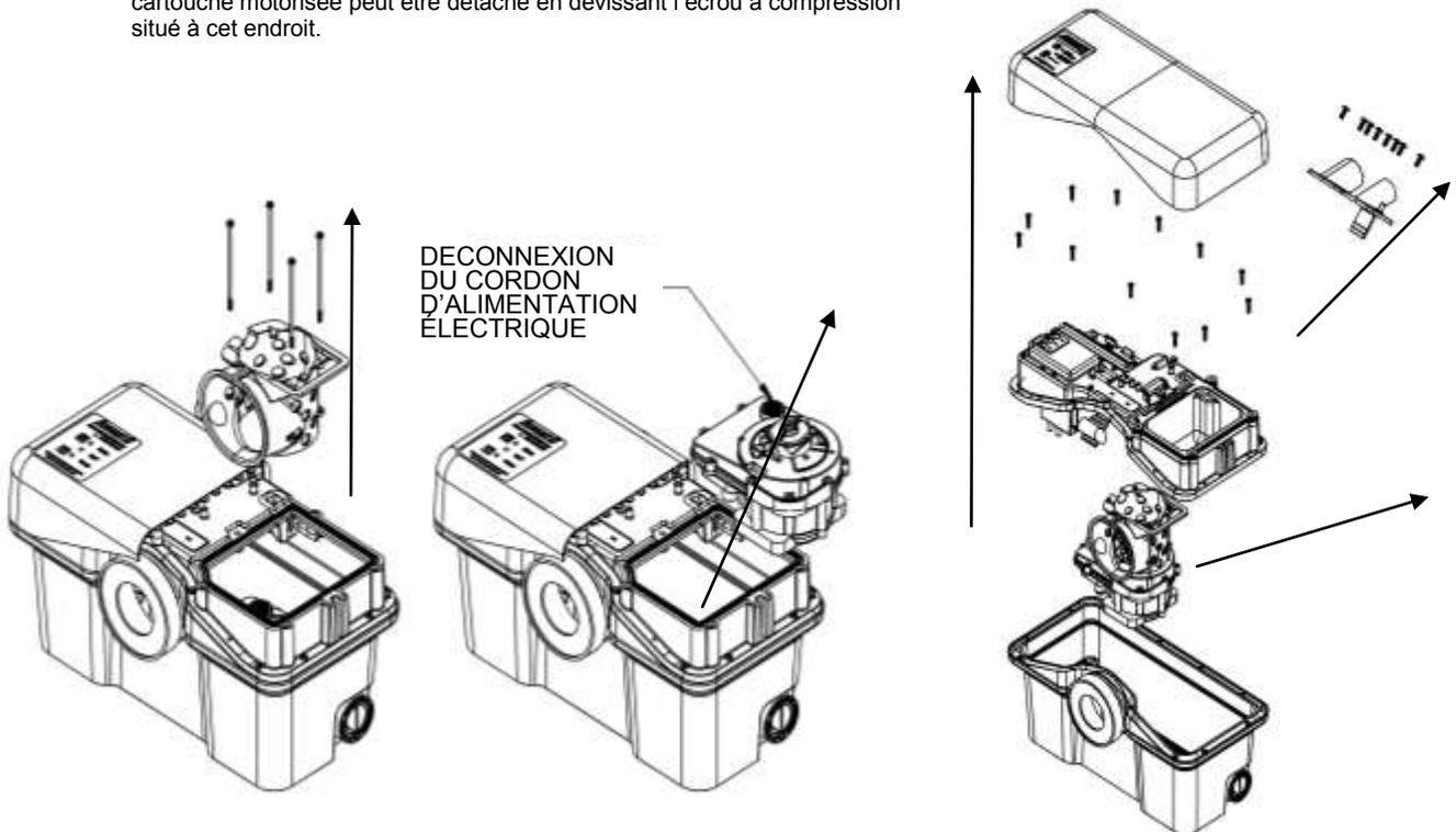
**4-3-6 Élimination du blocage du rotor/ remplacement du rotor :**
