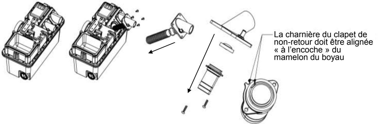
**4-3-4 Couvercle d'accès :** Le couvercle d'accès est solidement ancré au couvercle principal grâce à cinq pièces de fixation. Utiliser au besoin la clé Allen 3/16 fournie pour desserrer les pièces de fixation. Une fois les vis enlevées, le couvercle d'accès peut être soulevé. Une certaine manipulation peut s'avérer nécessaire si la pompe déchiqueteuse est située directement sous le réservoir de la toilette.
