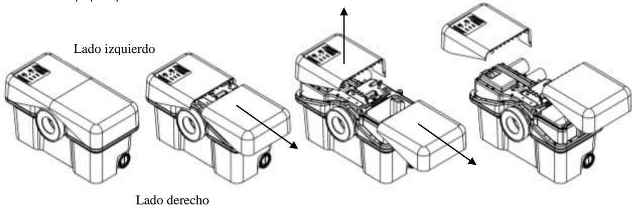
**4-3-2 Collarines de desagüe y de ventilación:** los collarines de desagüe y ventilación se encuentran fijos en su sitio por sujetadores en la tapa principal y se pueden extraer destornillando los cuatro sujetadores y sacando los collarines de la tapa principal.
