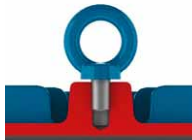
Bild 4.2 - Falsche Befestigung der Transportösen
