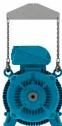
Figura 4.6 - Uso de barra separadora no içamento
