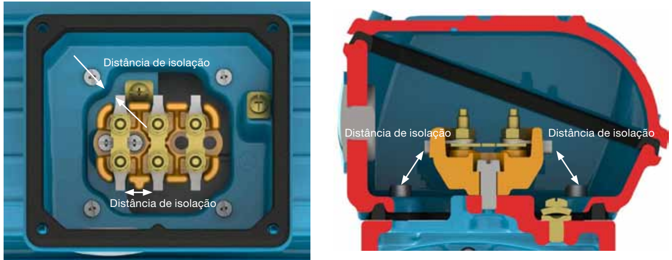
Figura 6.13 - Representação da distância de isolamento.
