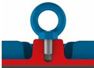
Bild 4.1 - Richtige Befestigung der Transportösen
