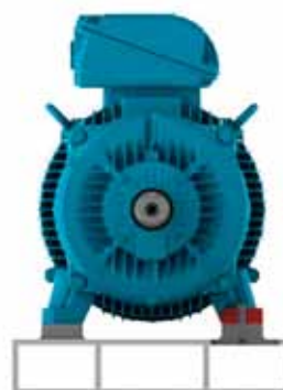
Figura 6.3 - Motor instalado sobre base metálica
