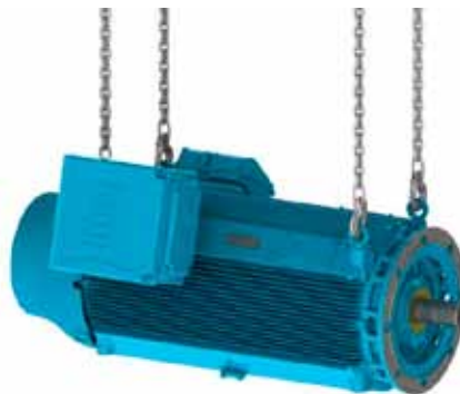
Figura 4.12 - Izamiento del motor HGF utilizando dos grúas
