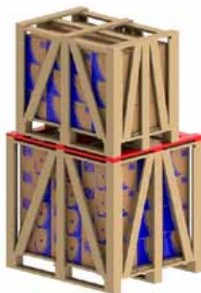
Figura 5.5 - Utilización de varas adicionales para apilamiento
