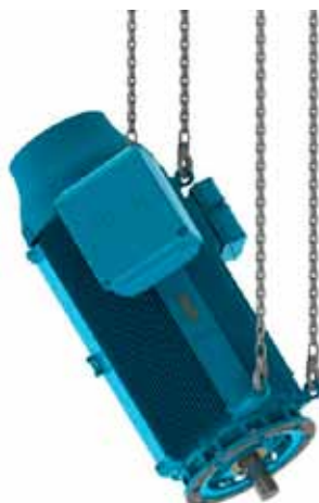
Figura 4.13 - Colocação de motor HGF na vertical
