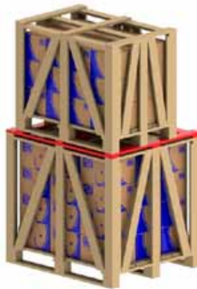
Figura 5.5 - Utilização de sarrafos adicionais para empilhamento
