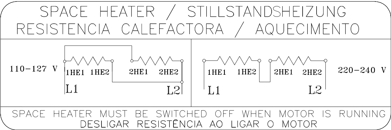
Bild 6.17 - Schaltbild der Stillstandsheizung für 110-127/220-240 V
