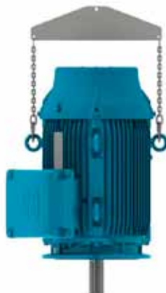
Bild 4.7 - Handhabung von vertikal aufgestellten Motoren
