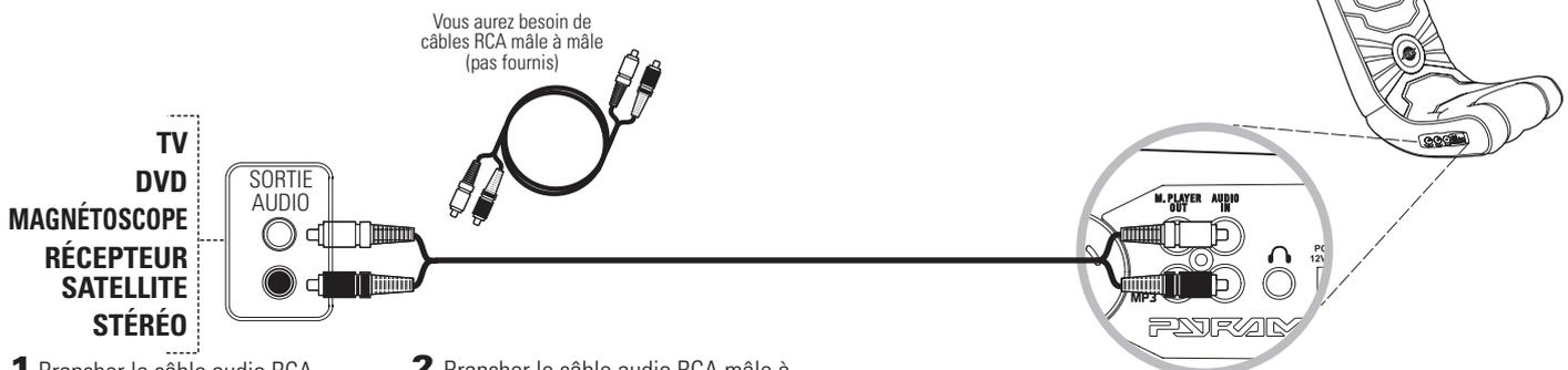
**1** Brancher le câble audio RCA mâle à mâle (pas fourni) à la source AUDIO OUTPUT (Sortie Audio) de l'appareil audio/vidéo.
