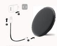
2 USB电源线一端连接适配器,一端连接无线充电器 \*LED状态指示:
