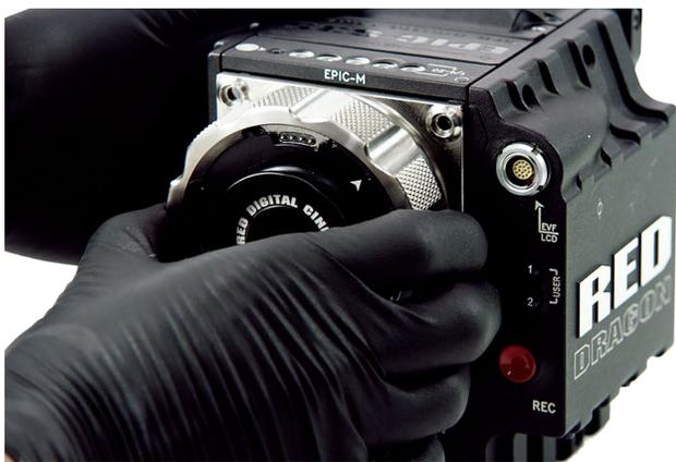
*Figure: Retire la Montura de la Lente*
