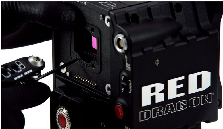
*Figure: Vuelva a colocar el Módulo OLPF y los Tornillos*
