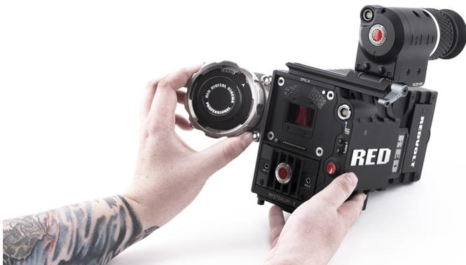
*Figure: Alinee los Pines de la Montura de la Lente*
