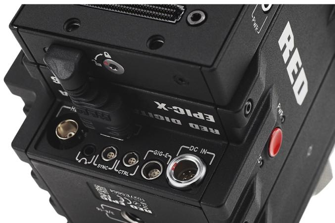
Figure: Inserte el Conector HDMI en el BRAIN
