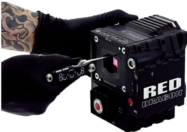
*Figure: Quite los Tornillos del Módulo OLPF*
