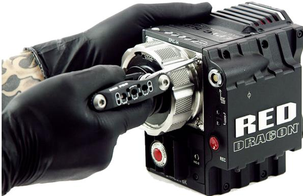
Figure: Reemplace la Montura de la Lente
