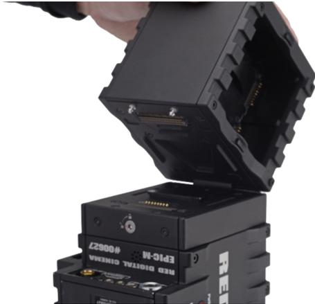
*Figure: Insertar el Borde del Módulo*
