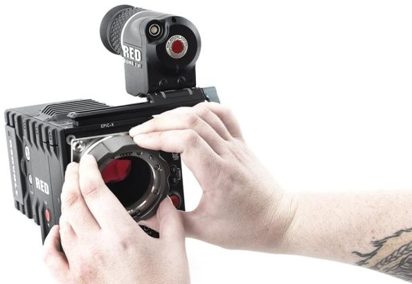
*Figure: Retire la Montura de la Lente*
