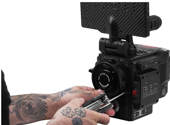
Figure: Entfernen Sie das OLPF-Modul
