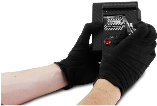
Figure: Verriegeln Sie den Back Focus
