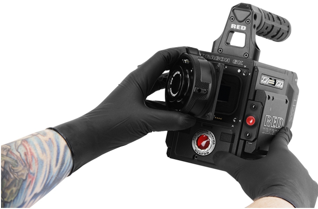
Figure: Ausrichten der Kontaktstifte des Objektivaufsatzes
