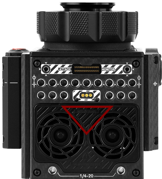
Figure: WiFi-Antenne darf nicht verdeckt werden
