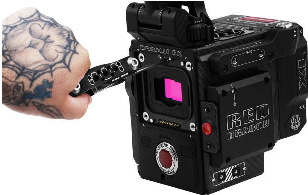
Figure: Drehen Sie die Verriegelung im Uhrzeigersinn
