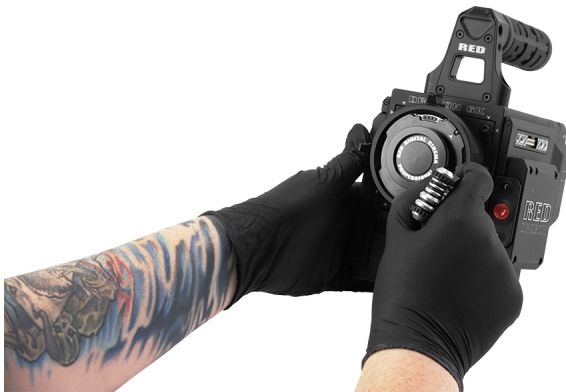
Figure: Entfernen Sie die Schrauben des Objektivaufsatzes
