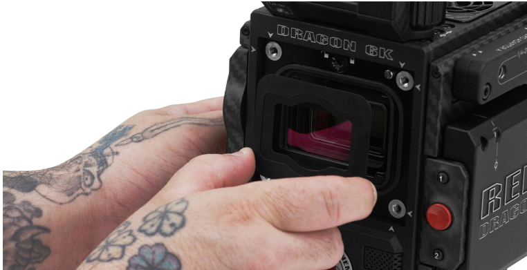
Figure: Entfernen Sie das OLPF-Modul
