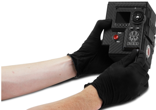
Figure: Entfernen Sie den DSMC2 Sidekick
