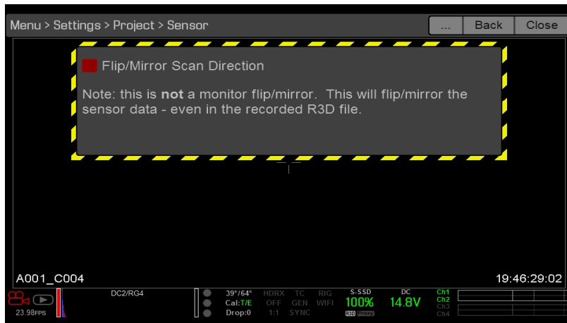
Figure: Flip/Mirror (Aufnahme um 180° drehen)
