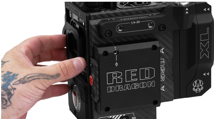
Figure: Installieren Sie das neue OLPF-Modul
