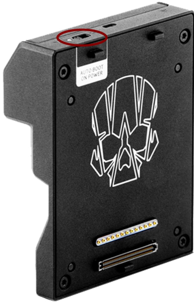
Figure: Auto Boot on Power-Schalter (Schalter zum automatischen Hochfahren)
