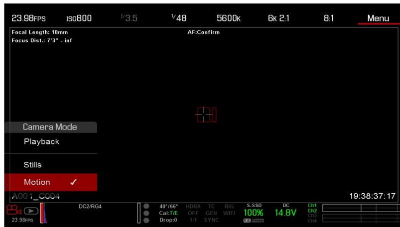
Figure: Faites glisser le doigt vers le haut pour sélectionner un mode de caméra
