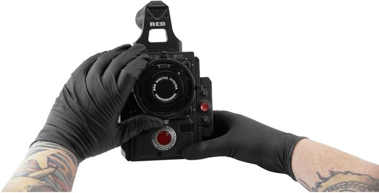
*Figure: Tournez la bague de verrouillage dans le sens antihoraire*
