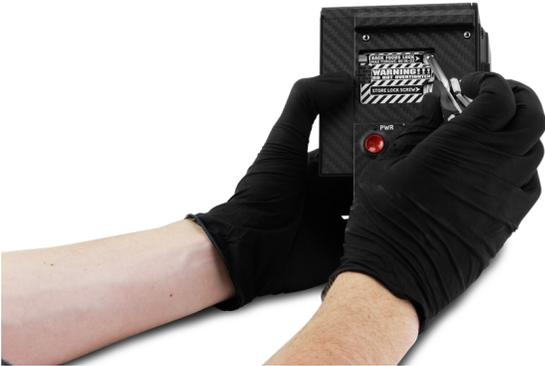
Figure: Verrouillez la mise au point arrière
