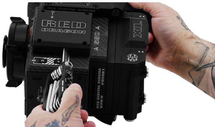
*Figure: Retirez le crochet de mise au point*
