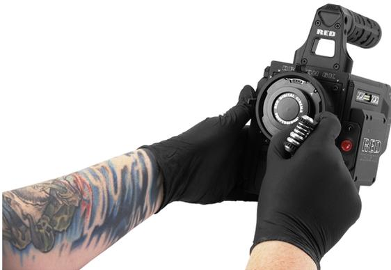
*Figure: Retirez les vis de la monture d'objectifs*
