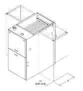
THE RXGR-C24B MAY ONLY BE INSTALLED ON THE SIDE OPPOSITE THE GAS AND **ELECTRICAL CONNECTIONS.**
