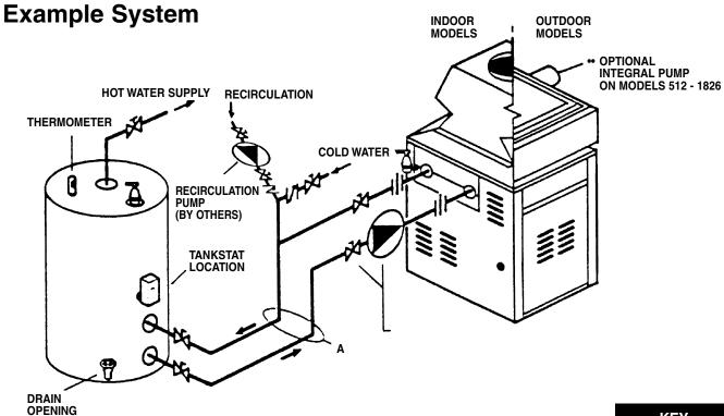
PUMP AND BALL VALVE LOCATION ON MODELS 136 THRU 399
