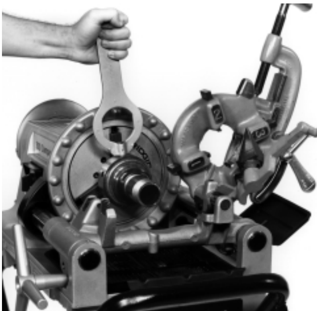
Figure 18 – Installation du raccord incomplet et libération du raccord fini à l'aide de la clé
