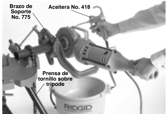
Figura 4 – Roscado de un tubo de 2 pulgadas con el Accionamiento ubicado al lado izquierdo de la Prensa de tornillo
