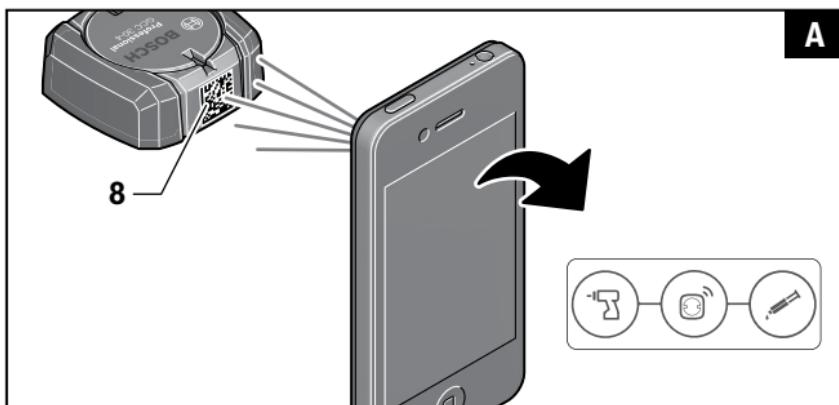
Esto significa que el módulo GCC30-4 está claramente identificado y se puede asignar a una configuración de inventario en el software.
