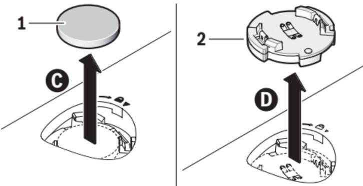
**C.** Jale hacia fuera la batería tipo botón/moneda **1** hasta retirarla y deséchela o almacénela adecuadamente. Retire solamente la batería usada utilizando los dedos. No use objetos afilados para retirar la batería.
