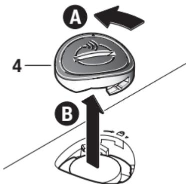
A. Déverrouillez le couvercle du module de connectivité **4** sur l'outil électrique en le faisant tourner dans le sens contraire des aiguilles d'une montre avec un tournevis à tête plate ou une grande pièce de monnaie. L'utilisation d'objets non appropriés pourrait endommager l'électronique ou le couvercle.
