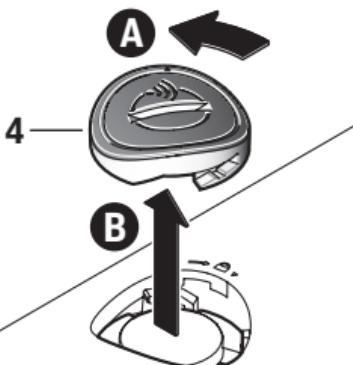
B. Levante la cubierta del módulo de conectividad **4** y póngala a un lado.
