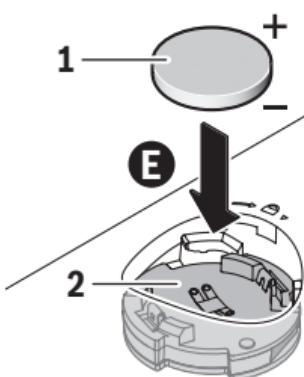
**E.** Insérez la pile en forme de bouton/pièce de monnaie **1** dans le module GCY30-4 **2** avec la borne orientée vers le haut. Il n'est pas nécessaire d'enfoncer la pile en appuyant dessus.
